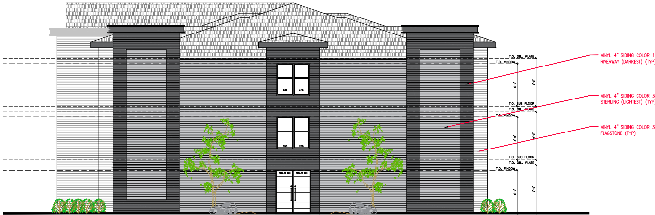
2 RIGHT ELEVATION A-202 SCALE: 1/8" =1'-0"
